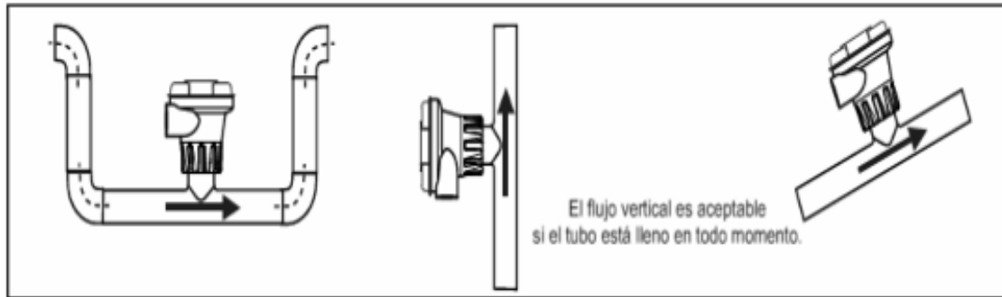
Figura N° 2 Disposición de la incorrecta instalación del medidor
