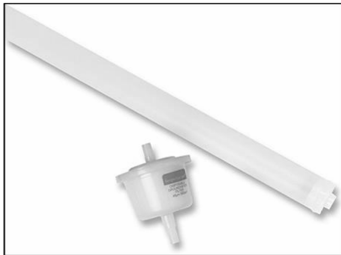
Figura 16 Muestreo en pozos profundos utilizando un bailler.
