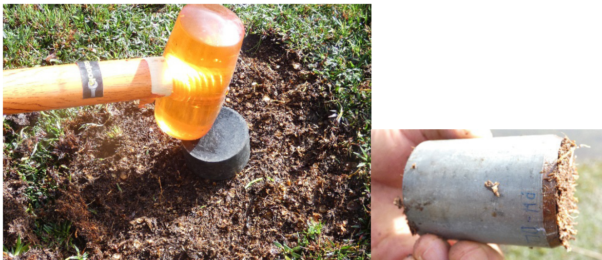
Foto n.º 5. Obtención de muestra para determinar la densidad aparente
