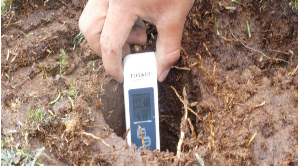
Foto n.º 7. Medición de la conductividad eléctrica en el bofedal del sitio 16
