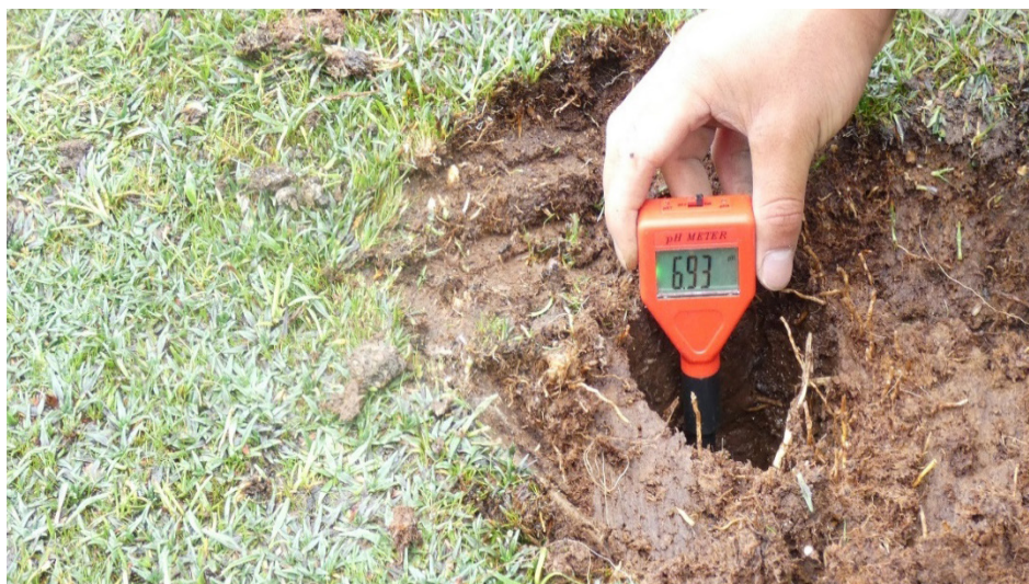
Foto n.º 6. Medición del pH del agua en el bofedal del sitio 16
