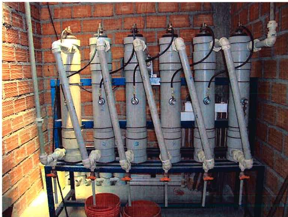
Fotografía 28. Celdas cilíndricas conectadas en serie.
