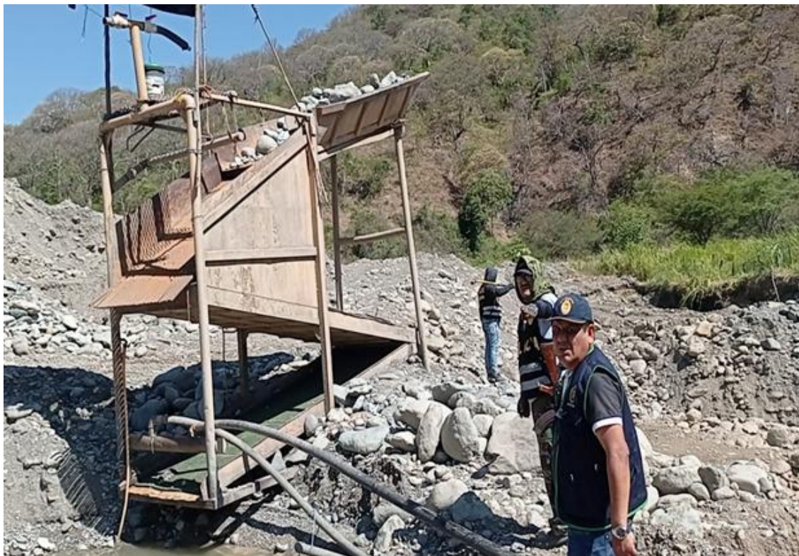
FOTO N°06: Otra toma fotográfica Clasificadora Tipo Z, empleado para el lavado de material aurífero pluvial
