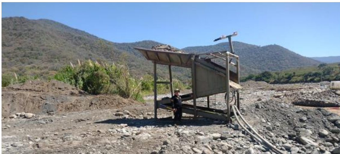
FOTO N°05: Clasificadora Tipo Z, empleado para el lavado de material aurífero pluvial
