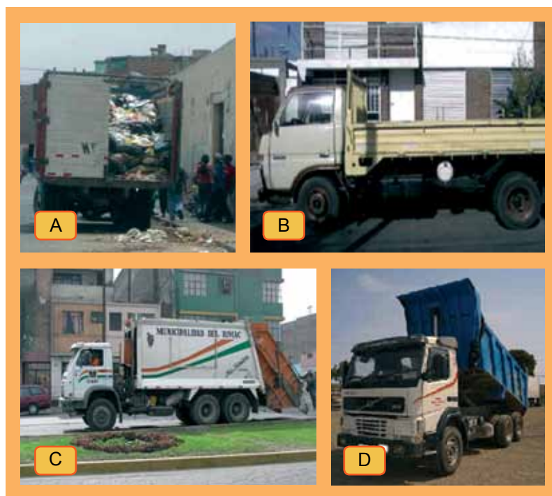
Figura N° 3.29: Unidades vehiculares de recolección convencional: A. Camión baranda. B. Camión semi baranda. C. Compactador. D. Camión volquete.
