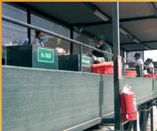
Figura N° 3.36: Los residuos pasan a la faja transportadora, donde son clasificados por el personal capacitado.
