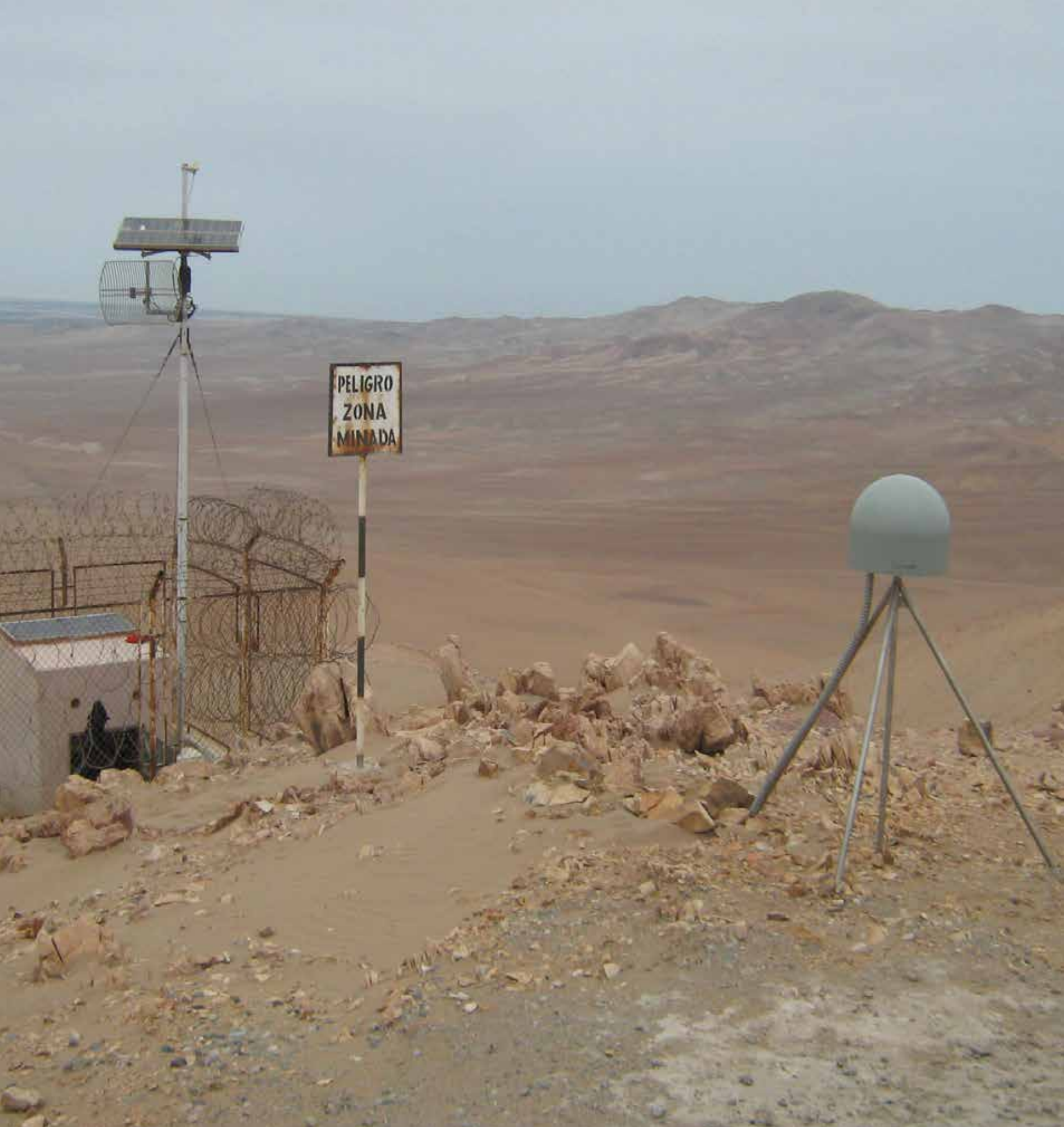
Estación GPS instalada en La Yarada - Tacna.
