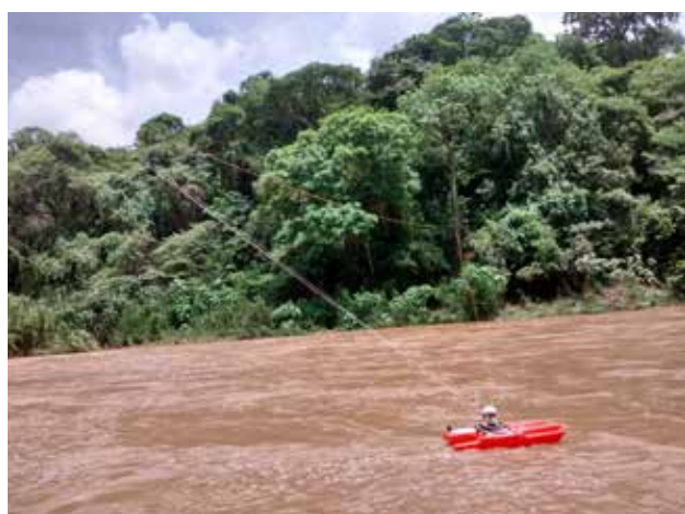
Campaña de medición de grandes avenidas en los ríos del norte del Perú (2015-2016). Aforo líquido realizado con ayuda del perfilador de corriente ADCP, el 25 de febrero del 2016 en la Estación hidro-sedimentológica Palmales, cuenca binacional del Río Zarumilla (Q=54 m3.s-1).
