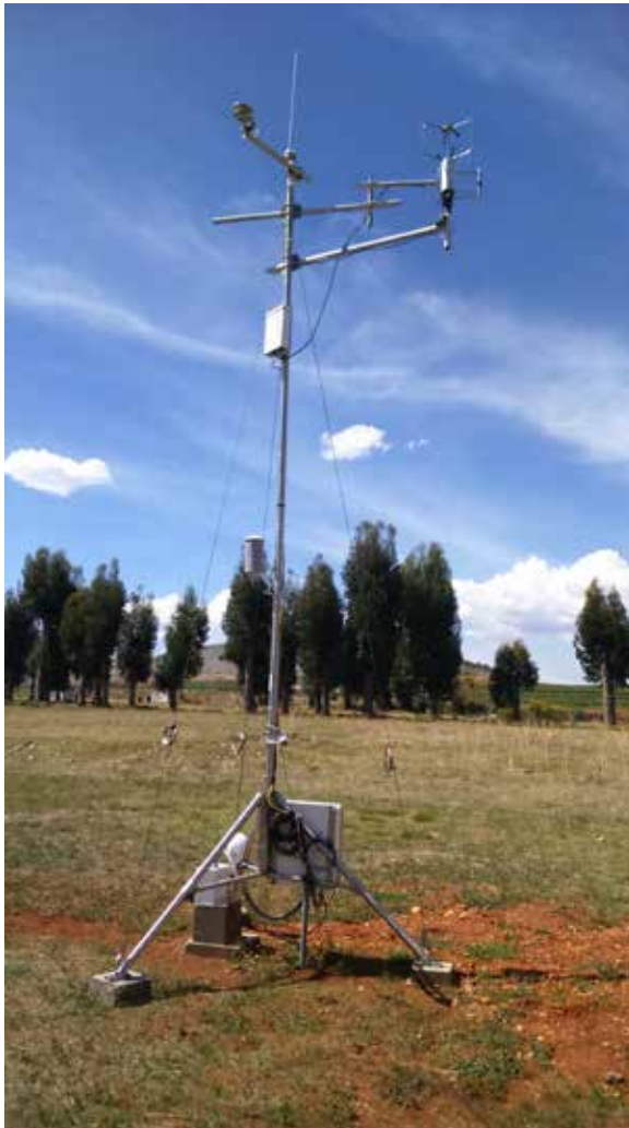
Torre de flujos instalada en LAMAR.
