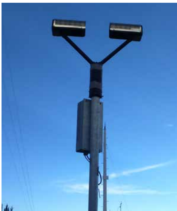
Disdrómetro óptico, usado para detectar el tamaño de las partículas que atraviesan el haz láser entre el emisor y el receptor
