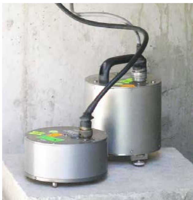
Equipos de la Red Acelerométrica Nacional.
