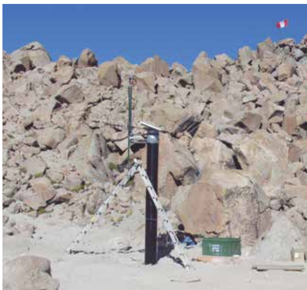
Estación sísmica telemétrica Ticsani, instalada sobre el domo reciente de este macizo.
