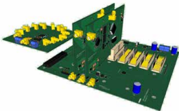
Modelo 3D del nuevo sistema de adquisición JARS 2.0
