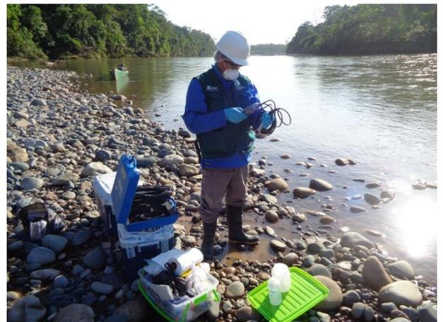
Foto N° 010: Preparación del equipo multiparametro para el registro de datos de campo de la calidad del agua en el río Karene (Colorado) – RKare 1. Octubre, 2016.
