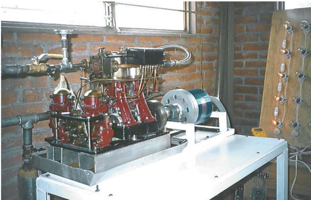
*Fig 8.17 Motor de pistones impulsado con vapor, utilizado en la planta solar*
