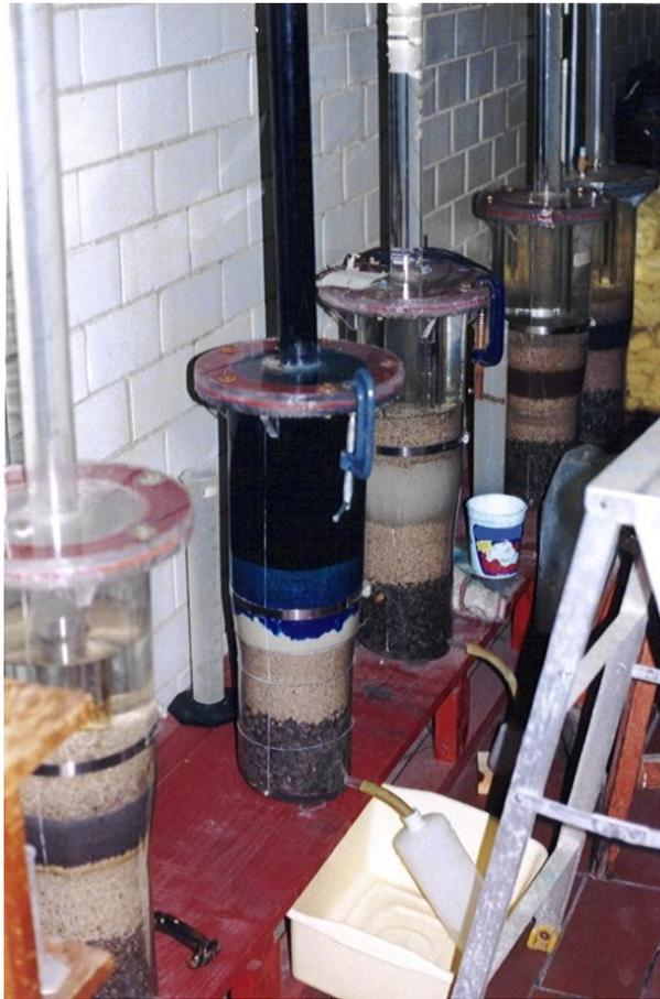
*Fig 8.13 Permeámetros utilizados en el estudio de arcillas para estanques solares*
