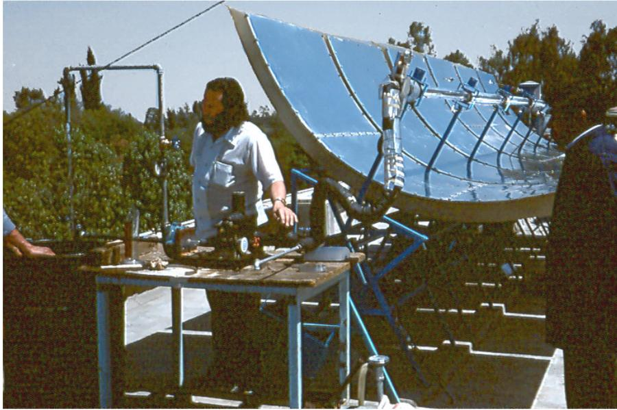
*Fig 8.14 Planta solar de 1kW*
