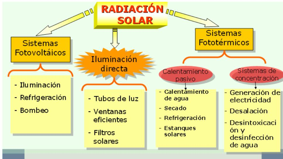
Fig 8.6 Diferentes tipos de tecnologías contempladas con energía solar
