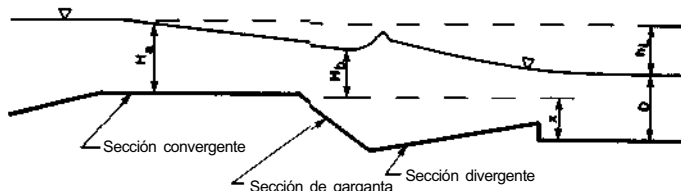
FIGURA 8.23 Perfil del medidor Parshall para el ejemplo 8.3
