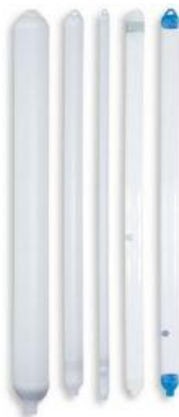
Figura 178. Tipos de bales para muestreo de agua subterránea. Izquierda: Bailers en acero inoxidable. Fuente: (Solinst, 2017d). Derecha: Bailers en plástico. Fuente: (Yacutec, 2017)
