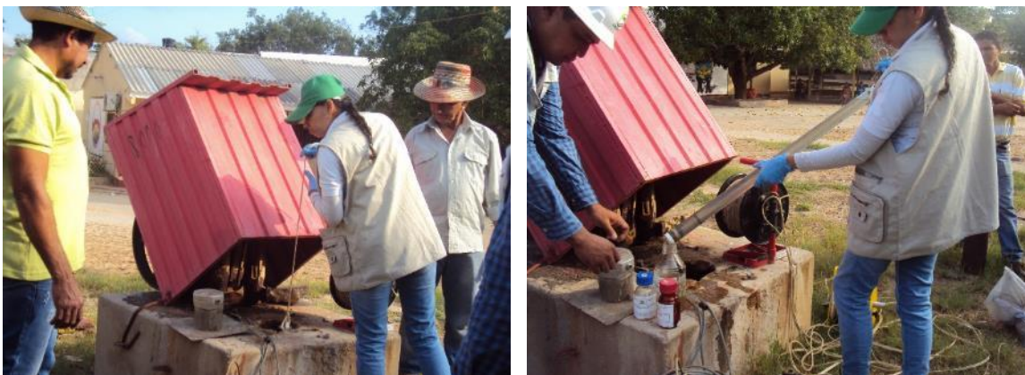
Figura 179. Muestreo en pozos profundos utilizando un bañilero. Información cedida por Corpogujaira de muestreo del pozo profundo Internado Aremasain- Rihacha, en campañas de muestreo de enero de 2017.
