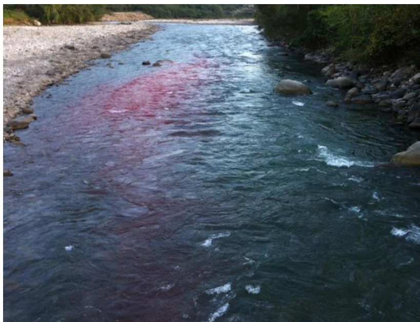
Figura 67. Ensayo con trazadores en el río Cravo Sur en el sector de La Cabaña, Yopal, Casanare. Fuente: Archivo Empresa Fluvia, 2014
