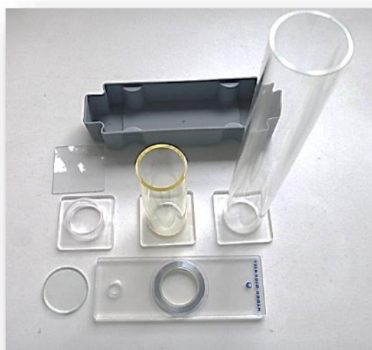
Figura 125. Cámaras de sedimentación Utermöhl. Fuente: Angela Zapata (2017)
