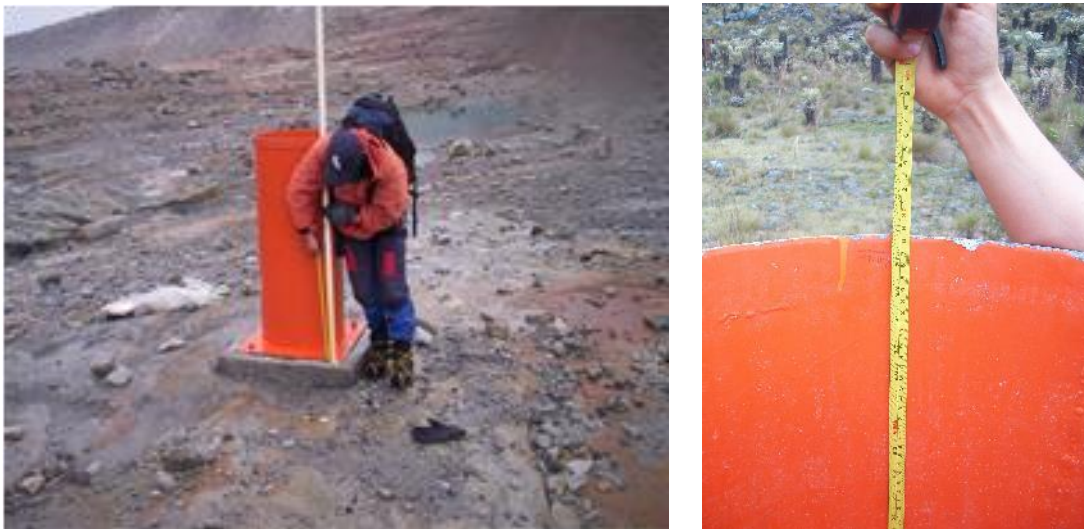
Figura 34. Medición con flexómetro de precipitación en un pluviómetro totalizador ubicado en el sector de XXXX. Fuente: Fotos de campañas de monitoreo de glaciares colombianos, 2005. Archivo Grupo de Suelos y Tierras- Subdirección de Ecosistemas e Información Ambiental- IDEAM.
