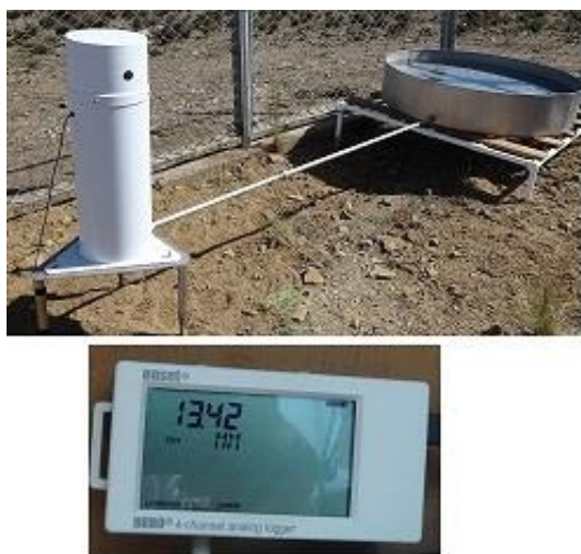
Figura 38. Tanque de evaporación automático. Fuente: (Agromatic S.A., 2016).
