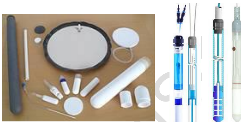
Figura 181. Copas de Succión para Muestreo de Agua del Suelo – Lisímetros. Izquierda: Copas de Succión (lisímetros) para el muestreo de agua del suelo para análisis químicos. Derecha: Muestreador de agua del suelo con almacenamiento del agua en el vástago.
