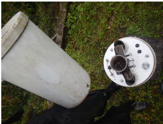
Figura 22. Pluviómetro de balancín utilizado en algunas estaciones del IDEAM. Fuente: Área Operativa 11-IDEAM 2017.
