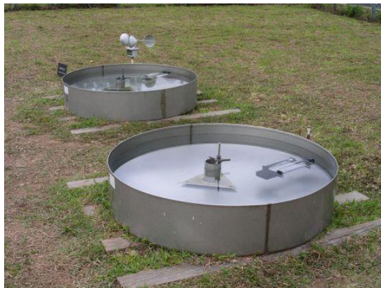
Figura 36. Detalles del tanque de evaporación. Se observa un termómetro flotante y un anemómetro situado cerca al tanque. Fuente: (Hong Kong Observatory, 2003)
