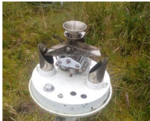
Figura 22. Pluviómetro de balancín utilizado en algunas estaciones del IDEAM. Fuente: Área Operativa 11-IDEAM 2017.
