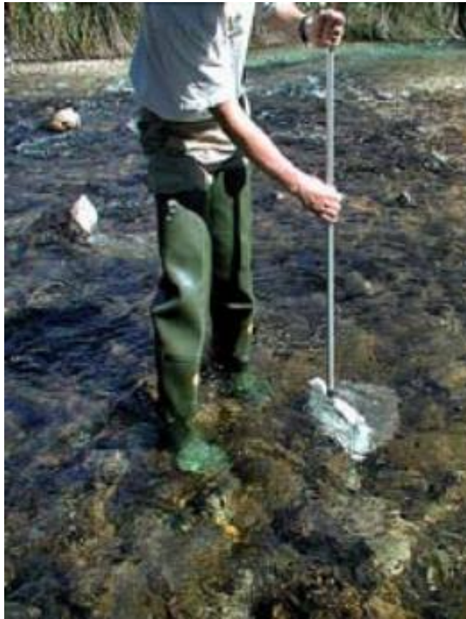
Figura 1438. Toma de muestra de macroinvertebrados acuáticos con Red Rectangular. Foto: J. Alba Tercedor. Tomada de Metodología para el establecimiento del Estado Ecológico según la Directiva Marco del Agua. Protocolos de muestreo y análisis para Invertebrados Bentónicos. 2005
