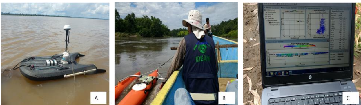
Figura 64. Medición de caudal en el equipo ADCP. A. río Amazonas, B. río San Juan, C. Transmisión del ADCP al computador, con información de: perfil transversal, caudal parcial, profundidad, distancia, velocidad del agua, velocidad de la barca. Estación Rumichaca, río Guáitara. Fuente. Áreas operativas 11 y 7 IDEAM, 2017.
