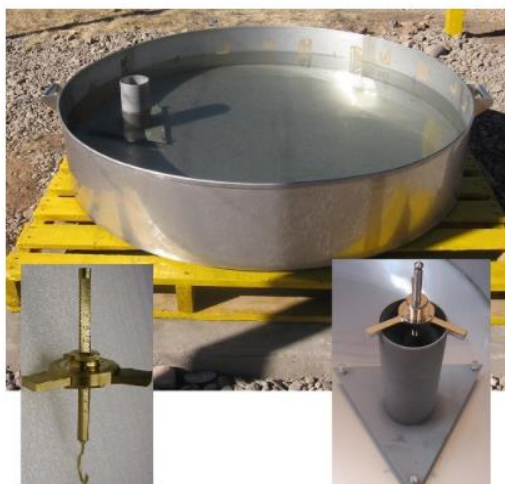
Figura 35. Tanque Evaporimetro clase "A" con Gancho graduado y tanque tranquilizador. Fuente: (Agromatic S.A., 2016)
