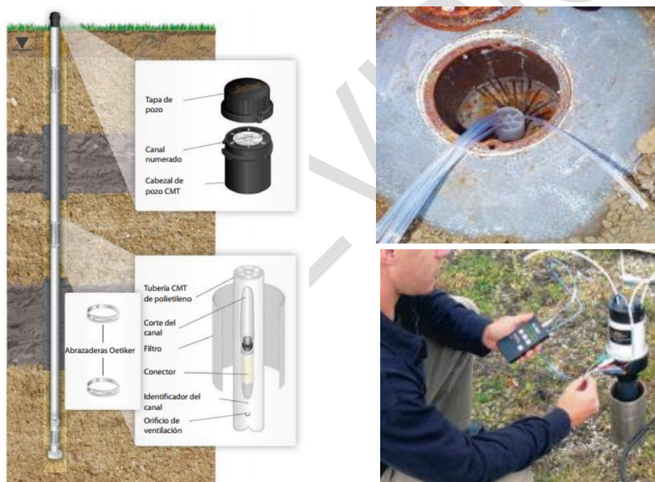
Figura 183. Muestreadores multinivel que permite el monitoreo de varias zonas en un sistema. Fuente: (Solinst, 2017b).
