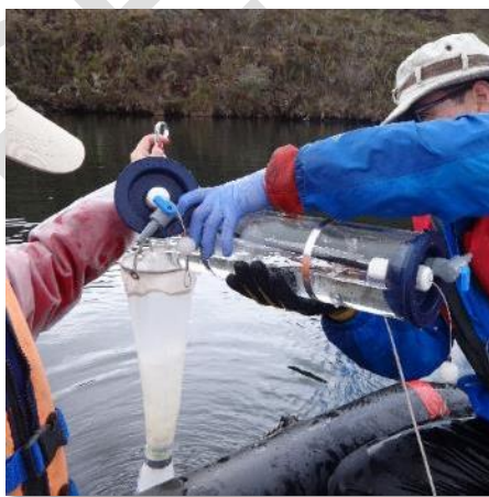
Figura 127. Concentración de muestra con botella Van Dorn y red de plancton.
