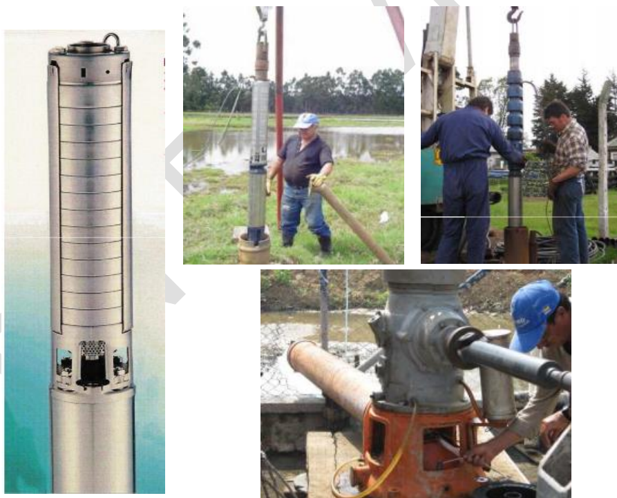
Figura 159. Bomba sumergible utilizada en pruebas de bombeo. Fuente: (Valencia Cuesta, s.f)
