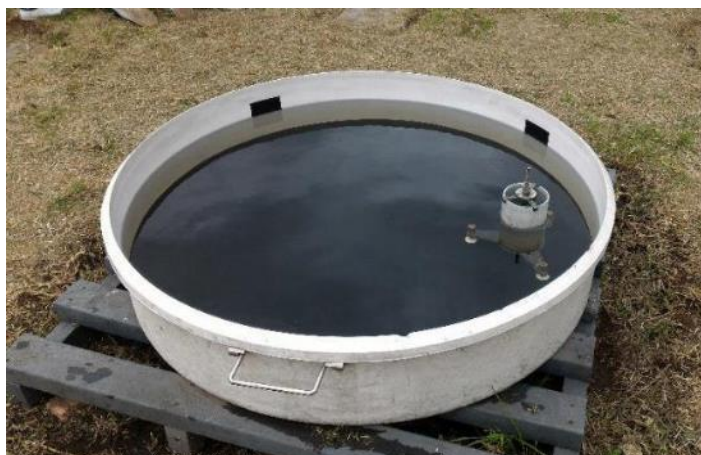
Figura 42. Tanque de evaporación utilizado en las estaciones meteorológicas del IDEAM, dotado de un tornillo micrométrico o gancho graduado, y un cilindro de reposo. Fuente: Campañas de mantenimiento estaciones Área Operativa 11. IDEAM 2017.
