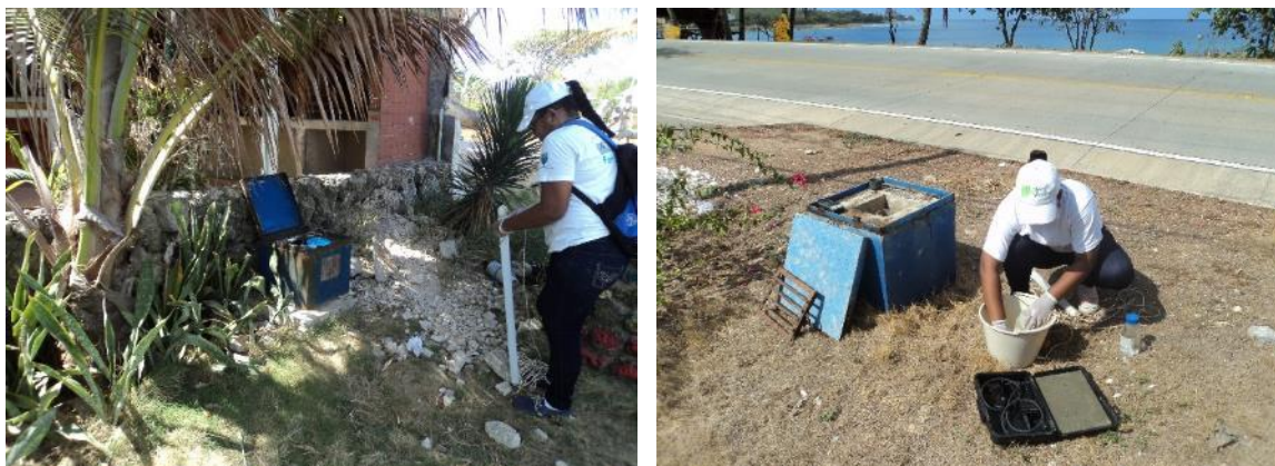
Figura 187. Muestreo en pozos profundos utilizando un bailler. Información cedida por Coralina de campañas de muestreo realizadas en el 2016.
