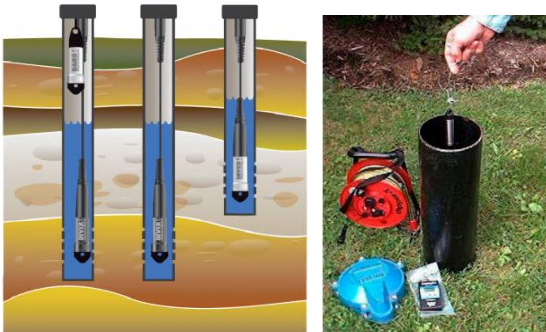
Figura 164. Medición de los niveles de agua subterránea utilizando un Diver. Izquierda, Fuente: (Schlumberger Water Services, 2014) ; Derecha, Fuente: (IDEAM, 2015).
