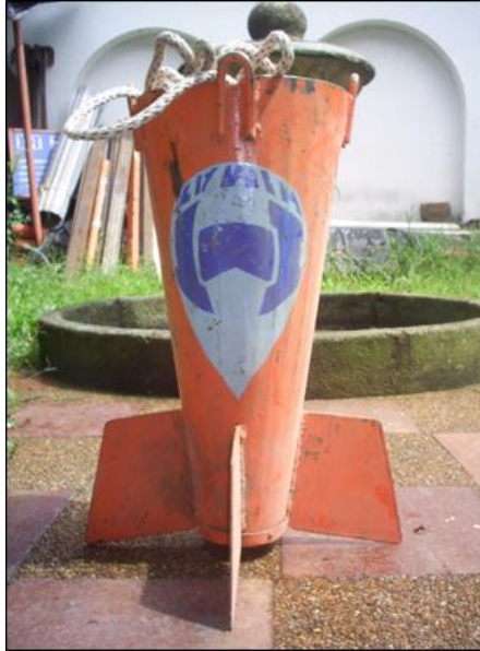
Figura 107. Muestreador de material de fondo usado en IDEAM. Fuente: Wilches H. IDEAM 2009.
