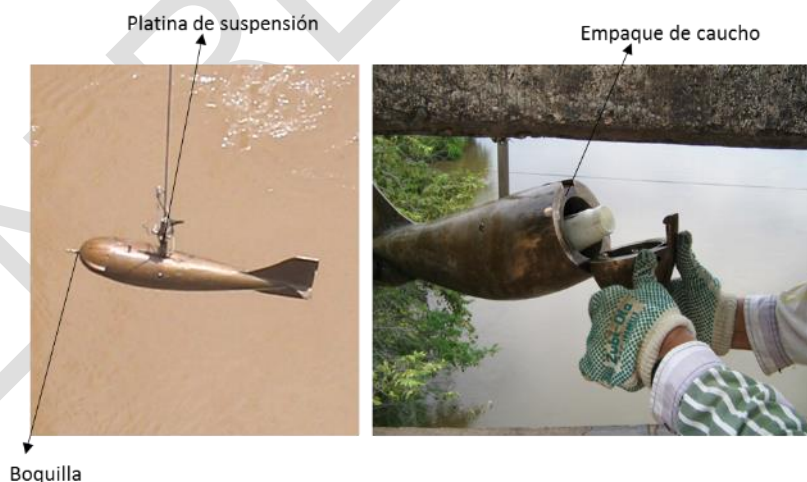
Figura 103. Integrador en Profundidad de Sedimento en Suspensión USD – 49. Izquierda. muestreador se sumerge en la corriente. Derecha. Muestreador es retirado para extraer la muestra.
