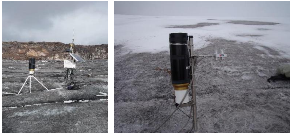
Figura 28. Pluviómetro EMMA instalado en el Parque Nacional Natural Los Nevados. Fuente: Fotos de campañas de monitoreo de glaciares colombianos, 2015. Archivo Grupo de Suelos y Tierras- Subdirección de Ecosistemas e Información Ambiental- IDEAM. .
