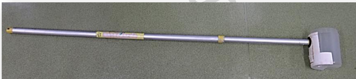
Figura 124. Pértiga telescópica modificada para toma de muestras sin disturbar los sedimentos en la zona litoral. Fuente: Angela Zapata (2017)
