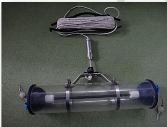
Figura 123. Botella muestreadora tipo Van Dorn horizontal para toma de muestras en profundidad.
