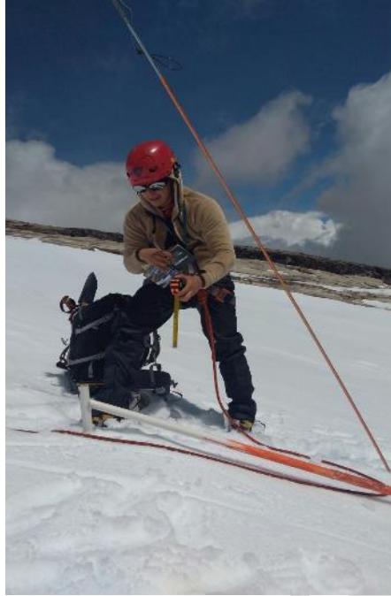
Figura 92. Ubicación de una baliza y captura de valores de espesor de nieve con el uso de una sonda para nieve. Fuente: Fotos de campañas de monitoreo de glaciares colombianos, IDEAM, 2012.
