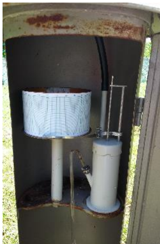
Figura 31. Izquierda: Tambor donde se inscribe la altura de la lámina del agua. Derecha: Grafico de registro continuo de las precipitaciones caídas. Fuente: Campañas de mantenimiento estaciones Área Operativa 11. IDEAM 2017.
