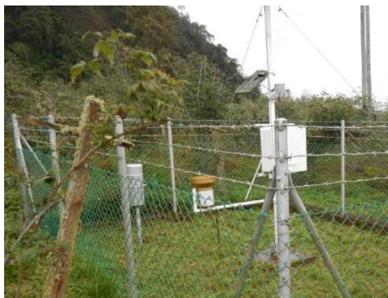
Figura 29. Pluviómetro convencional y pluviómetro digital ubicado en la Estación Meteorológica del Bata. Fuente: Campañas de mantenimiento estaciones Área Operativa 11. IDEAM 2017.
