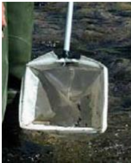
Figura66. Red Rectangular. Foto. J. Alba-Tercedor. Tomada de Metodología para el establecimiento del Estado Ecológico según la Directiva Marco del Agua. Protocolos de muestreo y análisis para Invertebrados Bentónicos. 2005
