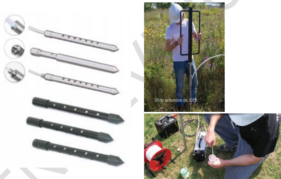
Figura 184. Tipos de piezómetros para hincar. Procedimiento de hincado de los piezómetros y toma de muestras. Fuente: (Solinst, 2017b).
