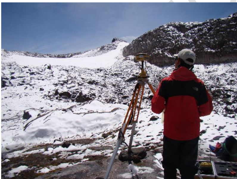
Figura 95. Levantamiento topográfico utilizando un GPS diferencial. Fotos de campañas de monitoreo de glaciares colombianos, IDEAM, 2017.
