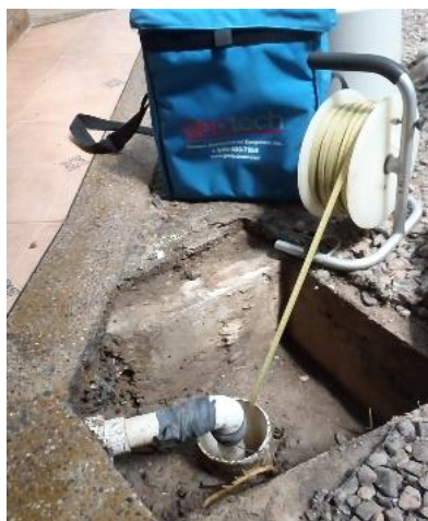
Figura 162. Izquierda: Monitoreo de niveles realizado en el Municipio de Puerto Gaitán. Fuente: (Cormacarena; SIAM S.A, 2016). Derecha: Esquema que ilustra la medición de niveles con el uso de una sonda manual (HYDROTECHNIK, s.f).
