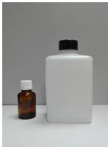
Figura 51. Frascos de muestreo isotópico de ^2\text{H} , ^{18}\text{O} y ^3\text{H} : frascos de 500 mL de polietileno de alta densidad y frascos de vidrio color ámbar de 30 mL, suministrados por la OIEA.
