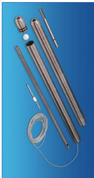
Figura 178. Tipos de bales para muestreo de agua subterránea. Izquierda: Bailers en acero inoxidable. Fuente: (Solinst, 2017d). Derecha: Bailers en plástico. Fuente: (Yacutec, 2017)
