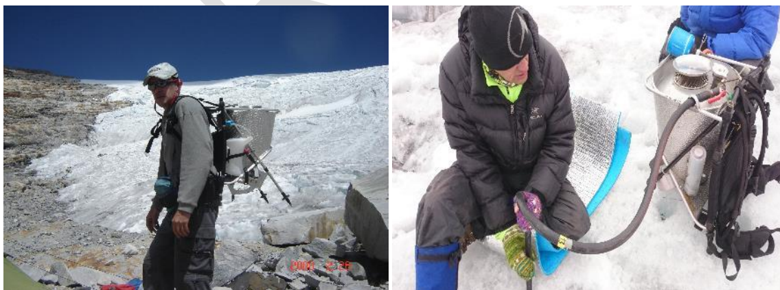
Figura 97. Izquierda: Detalle de perforadora Heucke. Derecha: Perforación de hielo empleando la perforadora Heucke. Fotos de campañas de monitoreo de glaciares colombianos, Sierra Nevada del Cocuy. IDEAM, 2008 y 2016.
