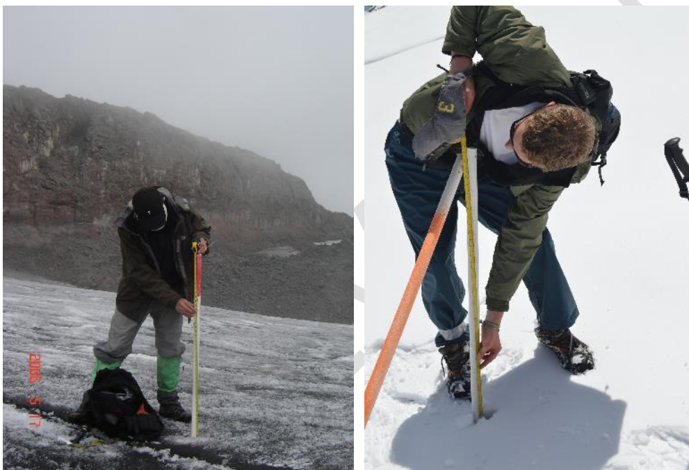
Figura 98. Medición de balizas. Fotos de campañas de monitoreo de glaciares colombianos, Parque Nacional Natural Los Nevados, IDEAM, 2006.
