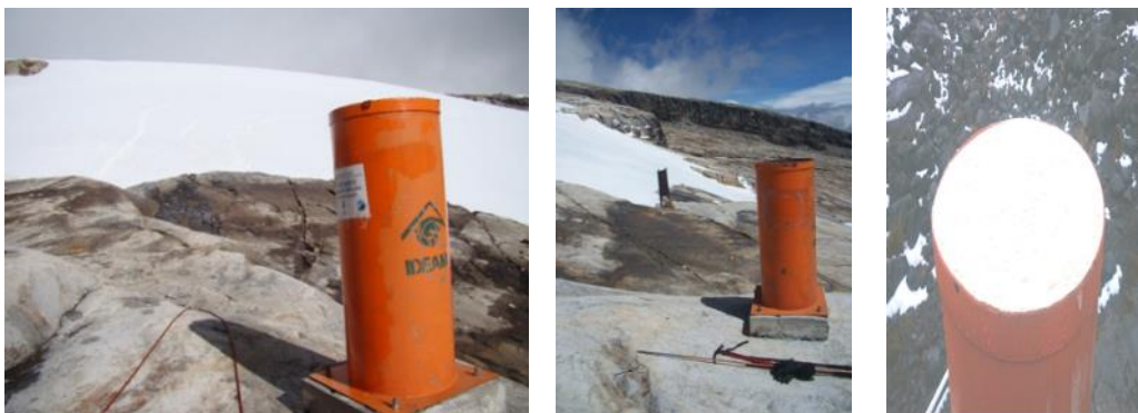
Figura 24. Pluviómetro totalizador de nieve del IDEAM ubicado en el Nevado del Cocuy- Ritacuba Blanco. Fuente: Fotos de campañas de monitoreo de glaciares colombianos, 2015. Archivo Grupo de Suelos y Tierras- Subdirección de Ecosistemas e Información Ambiental- IDEAM.
