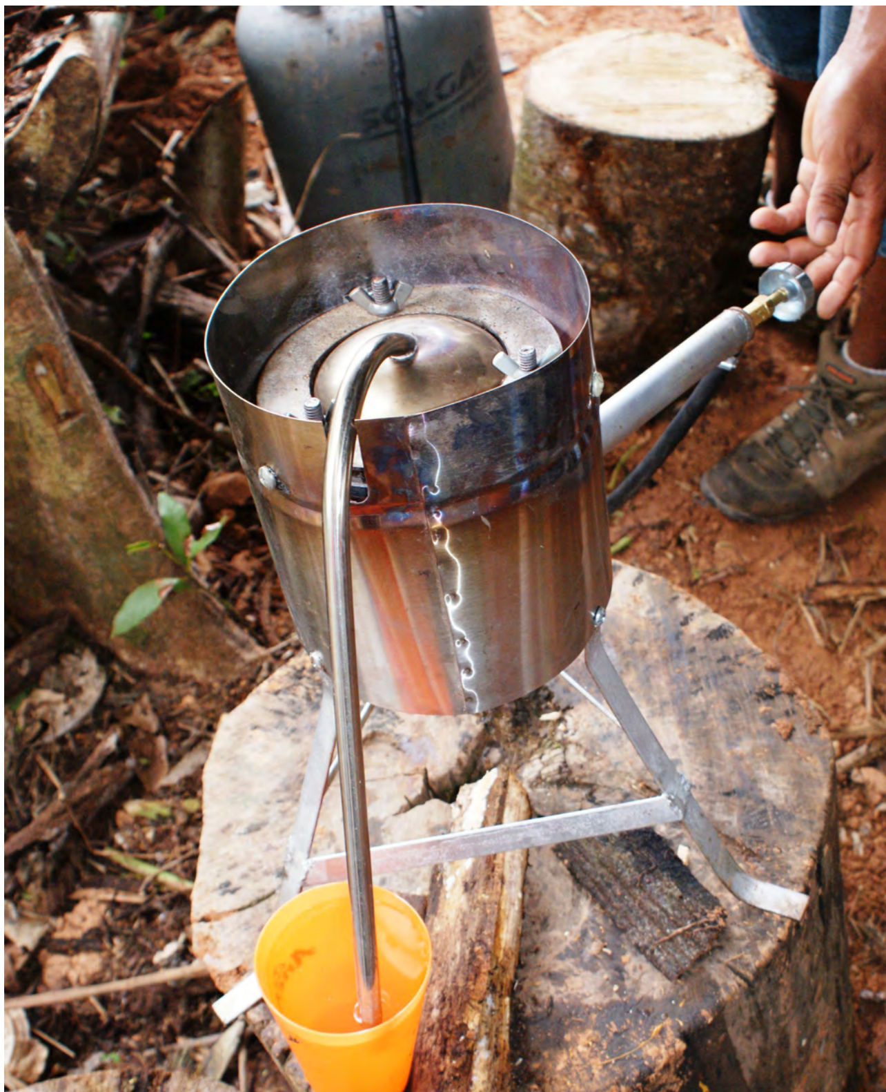
Retorta, artefacto que permite extraer el mercurio del oro y reduce la contaminación por mercurio en Madre de Dios
