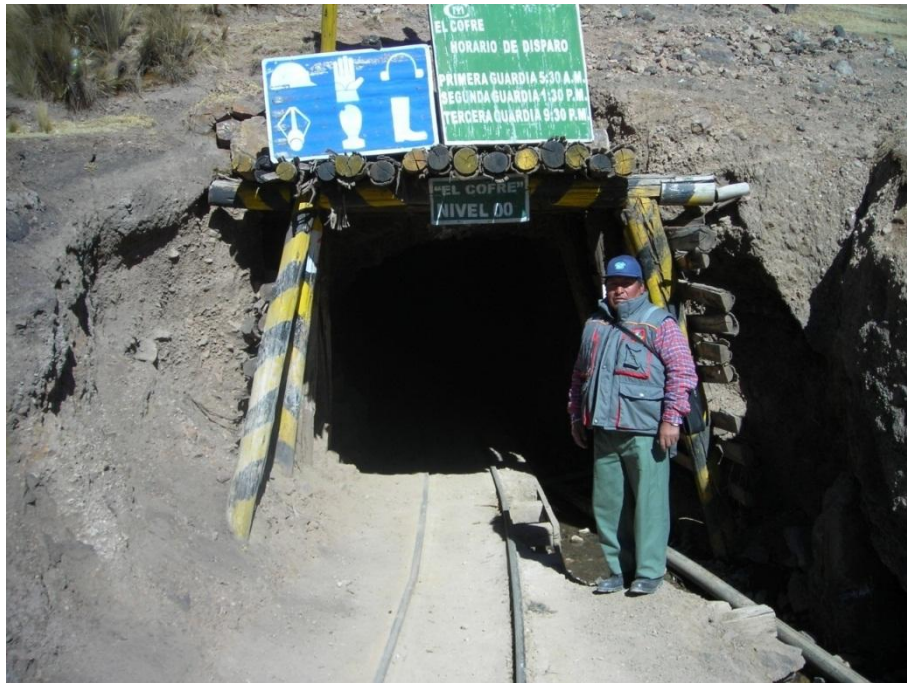
Foto 35: Bocamina del túnel de entrada a la Mina Orduña de la Empresa Minera CIEMSA (El Cofre), la mineralización contiene plata, cinc, cobre y oro en estructuras vetiformes (fuente Guillen 2010).
