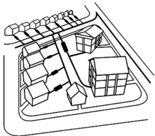
Figura 3: Alcantarillado de pequeño diámetro
