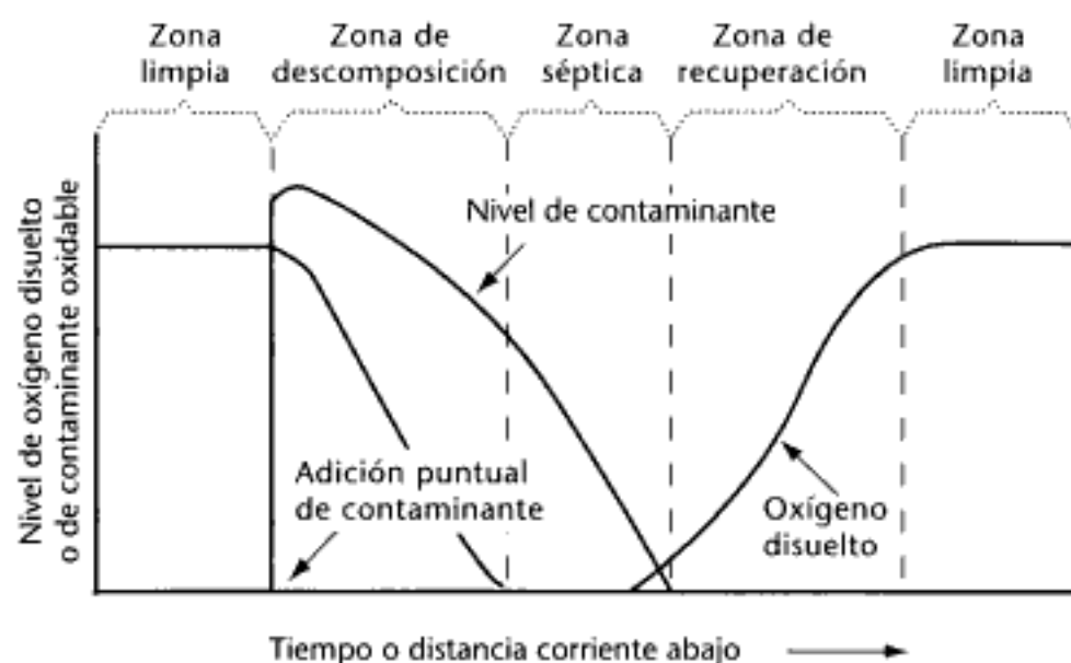
Figura 4.3 Curva de agotamiento de oxígeno que es el resultado de la adición puntual de material contaminante oxidable a un arroyo
