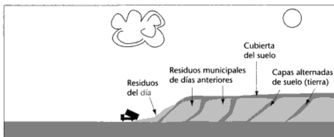
Figura 6.12 Estructura de un vertedero controlado
