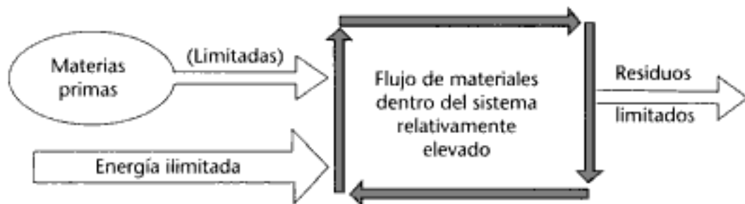
Figura 12.4 Ilustración de un sistema industrial donde se limitan, en cierto grado, la utilización de materias primas y la producción de desechos
