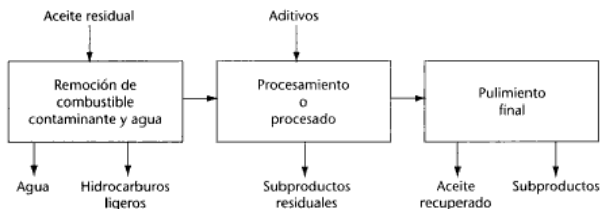
Figura 13.3 Etapas principales en la reelaboración del aceite usado
