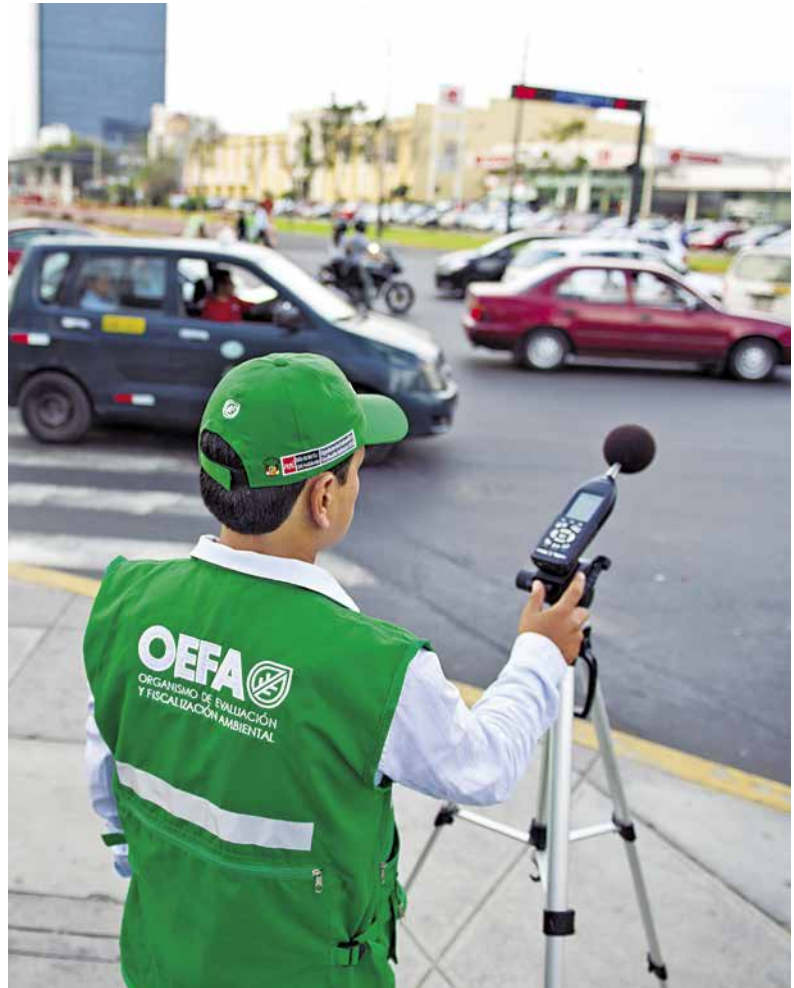
Medición de niveles de presión sonora. (Foto: OEFA)
