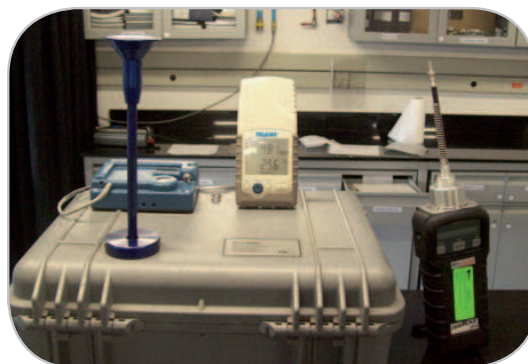
Equipos de monitoreo de la calidad del aire para espacios interiores
