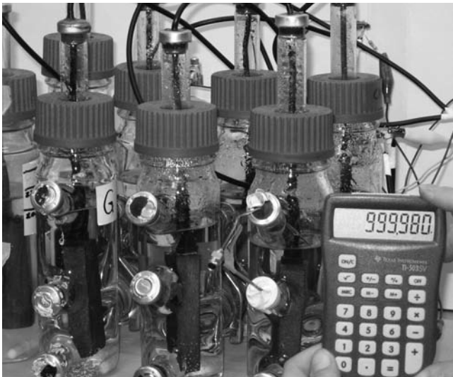
Figura 9.15 Células de combustible propulsadas por microbios Los investigadores de la Universidad de Massachusetts han demostrado que las células de los combustibles Geobacter pueden convertir eficazmente azúcares en electricidad.
