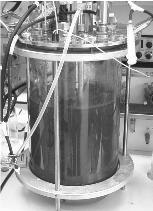
Figura 9.12 El biorreactor contiene Candidatus «Brocadia anammoxidans» , bacterias anaeróbicas que pueden degradar amonio. Las nuevas propiedades metabólicas permiten que estos anaerobios degraden el amonio de las aguas residuales en un solo paso.
