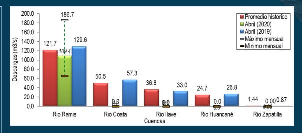
El caudal máximo observado del río Ramis llegó a 186.7 m3/s y el mínimo a 65.9 m3/s.
