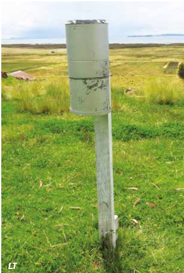
P-7 Pluviómetro Hellmann. Hellmann rain gauge.
