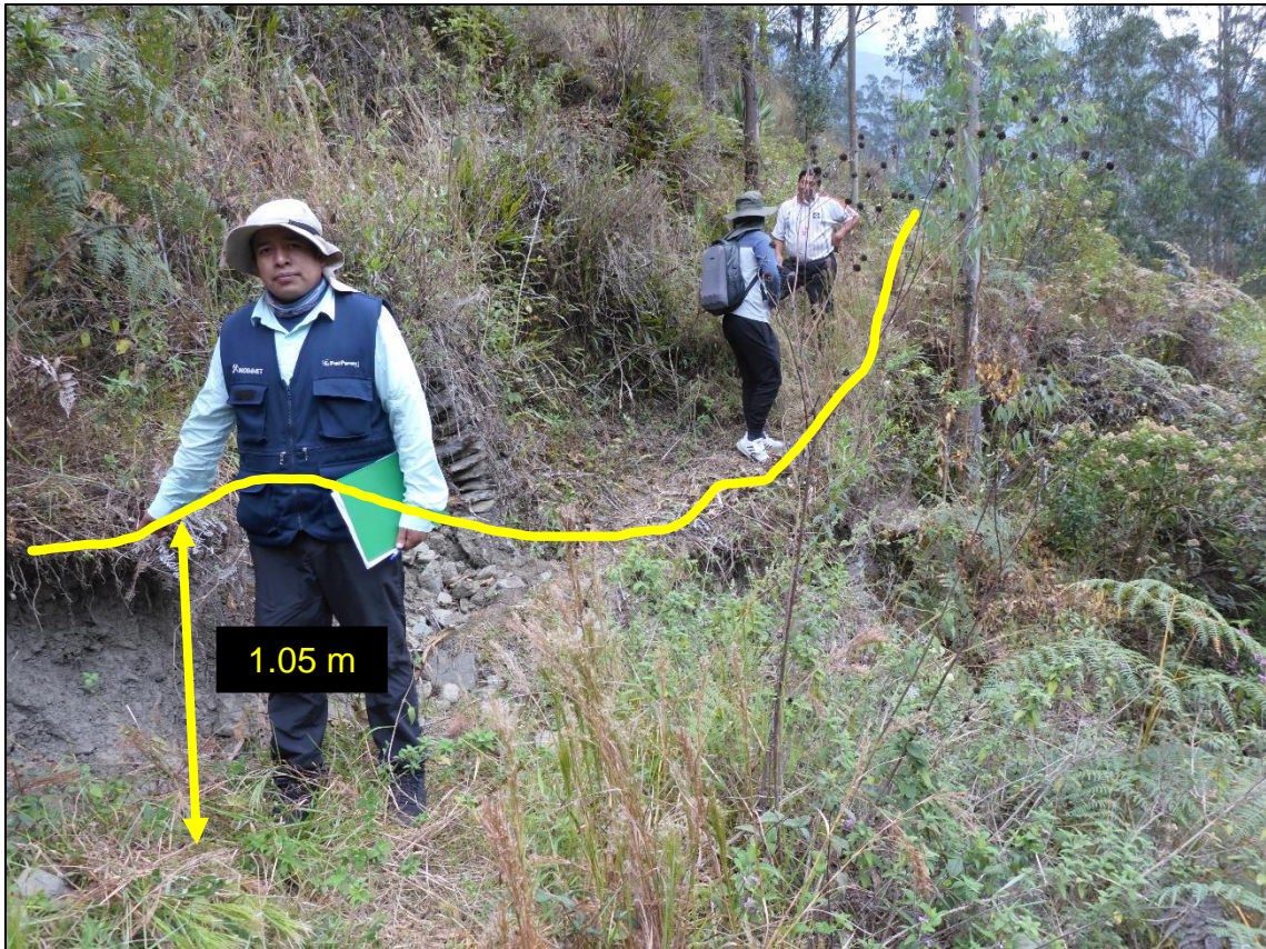
Figura 17. Escarpe secundario (ESP1) Pampa Tuana (coordenadas UTM E: 450809, N: 8415270).
