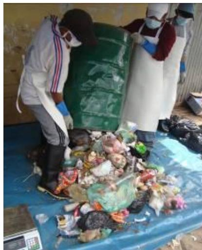
**Fotografía N° 9: Clasificación de los componentes**
