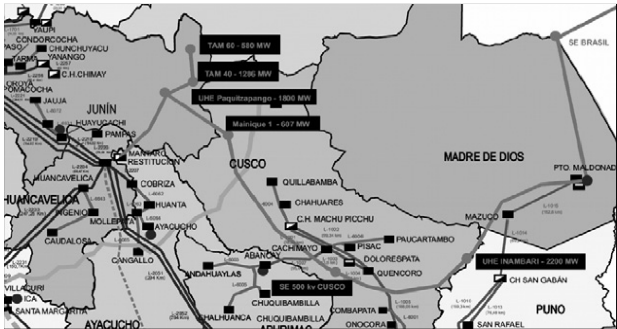
Mapa 13. Versión 1 de las líneas de transmisión: La interconexión del Inambari con el SEIN se haría a través de Paqitzapango y de la central del Mantaro (Restitución). La conexión de las centrales del Tambo con Brasil se haría a través del Inambari.
