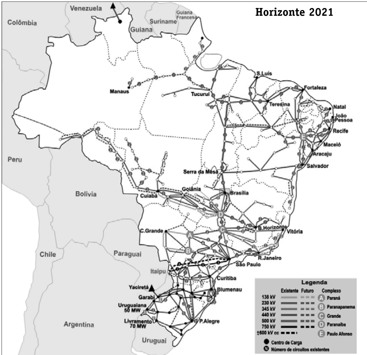
Mapa 2. El Sistema Interligado nacional del Brasil (SIN): La línea de transmisión del Inambari al Acre inyectaría energía en el SIN y también afianzaría el Sistema Eléctrico Interconectado peruano al vincularlo a uno mucho más grande. En el recuadro se ha considerado que el 80% de la potencia de las centrales de la Amazonía estaría dedicada para el Brasil.
