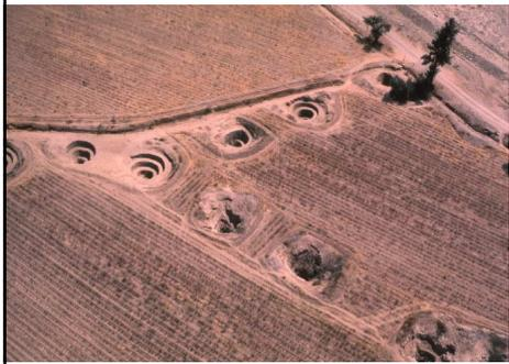
Son pozos horizontales: una zanja o Galería subterránea que conecta un Punto De la superficie con el agua Subterránea y estos se vacían en Qochas o canales de riego.
