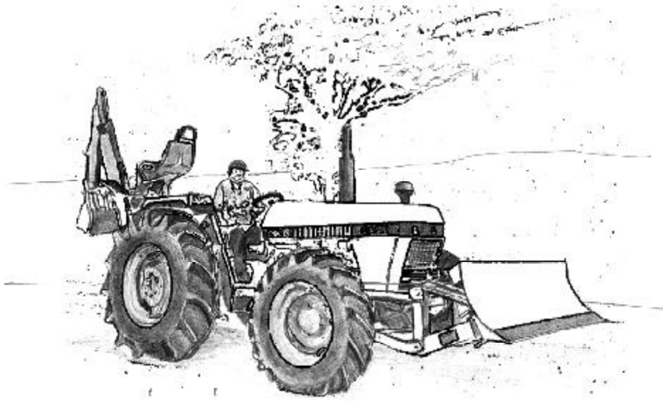
Figura 3.3 Tractor agrícola adaptado para las operaciones del relleno sanitario
