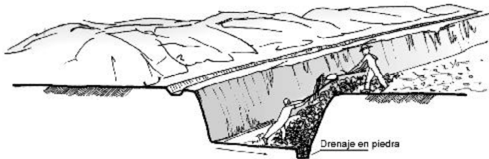
Figura 7.30 Descenso y nivelación de los RSM en la zanja
