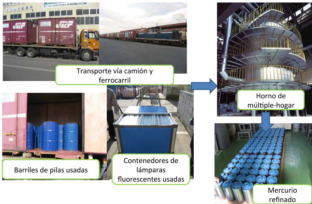
Fig.20 Recuperación de Mercurio de Productos Usados en la Antigua Mina
