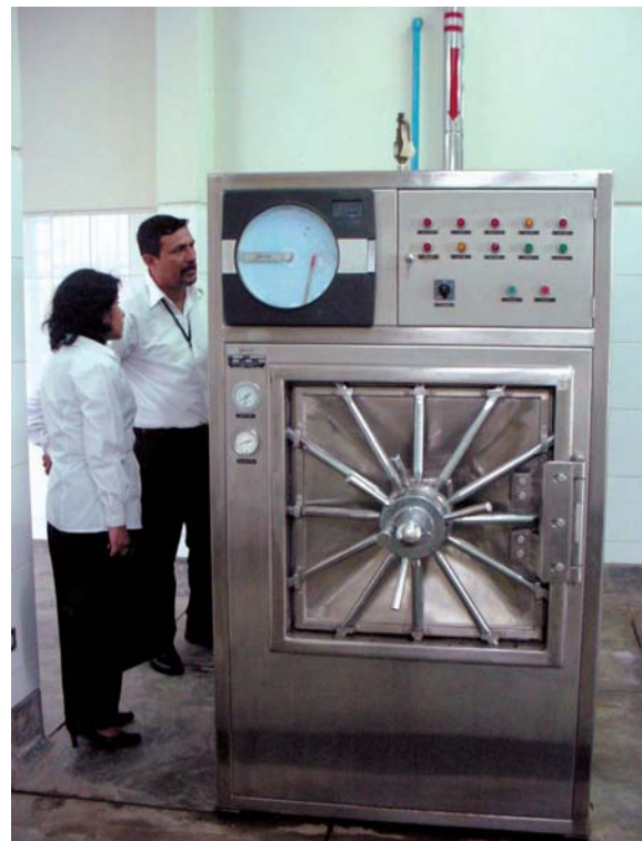
Módulo de Residuos Hospitalarios. Hospital Regional de Iquitos. Autoclave para tratamiento de residuos hospitalarios.
