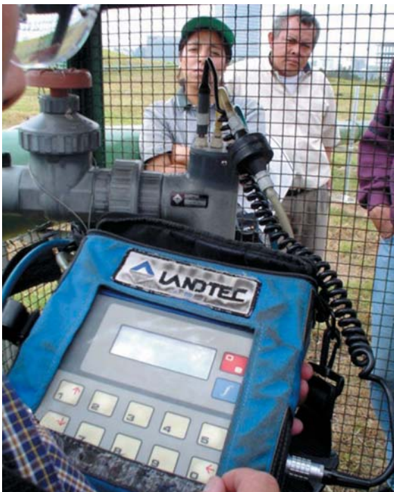
Relleno Sanitario Clausurado Prados de la Montaña. Monitoreo de gases.
