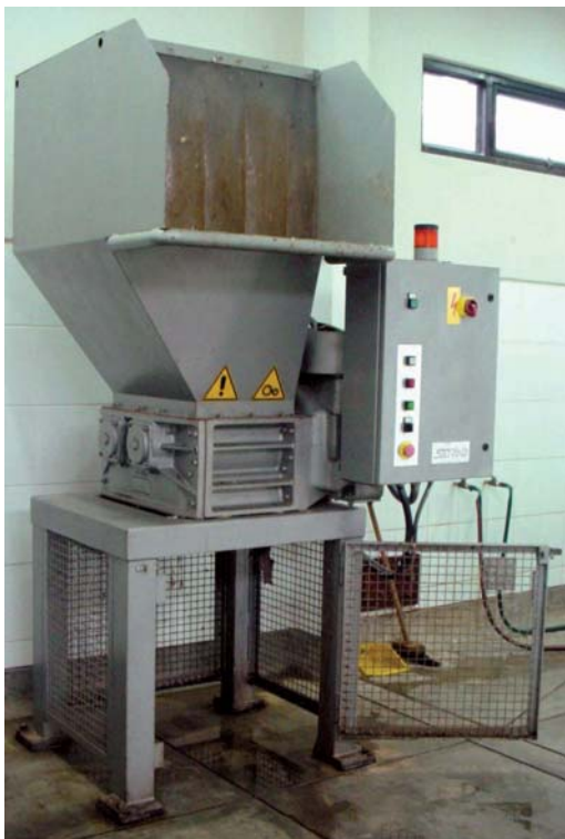
Trituradora de residuos hospitalarios
