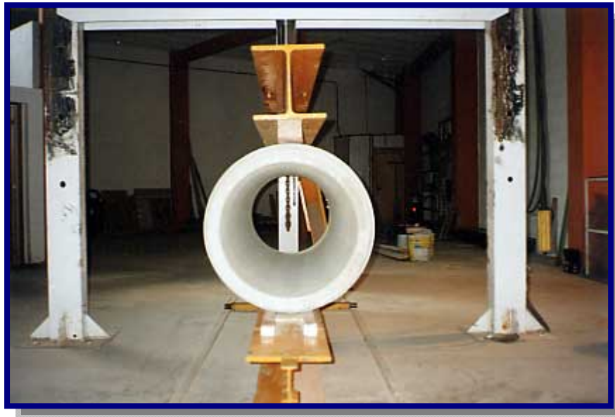
Figura 7.22: Prueba de las tres cuchillas visto de transversal [Ref. 29]
