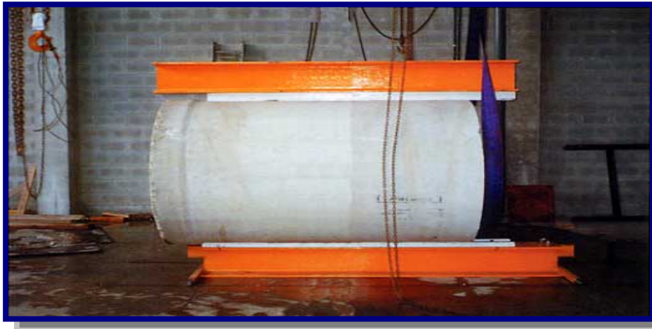
Figura 7.25: Prueba flexión longitudinal [Ref. 29]
