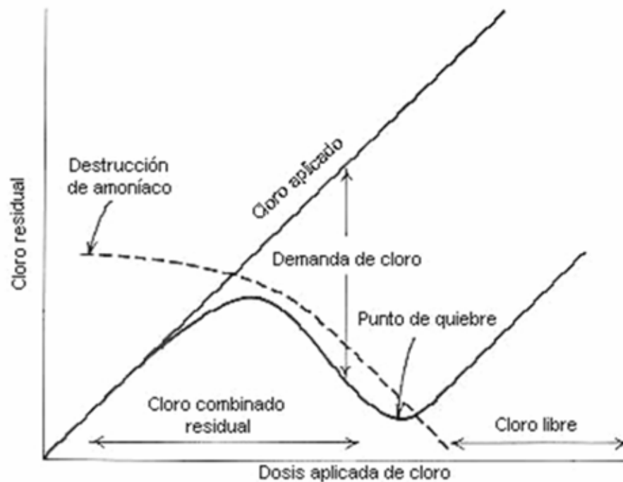
Figura 6.13 Curva de cloración a punto de quiebre (Hammer, 1986)
