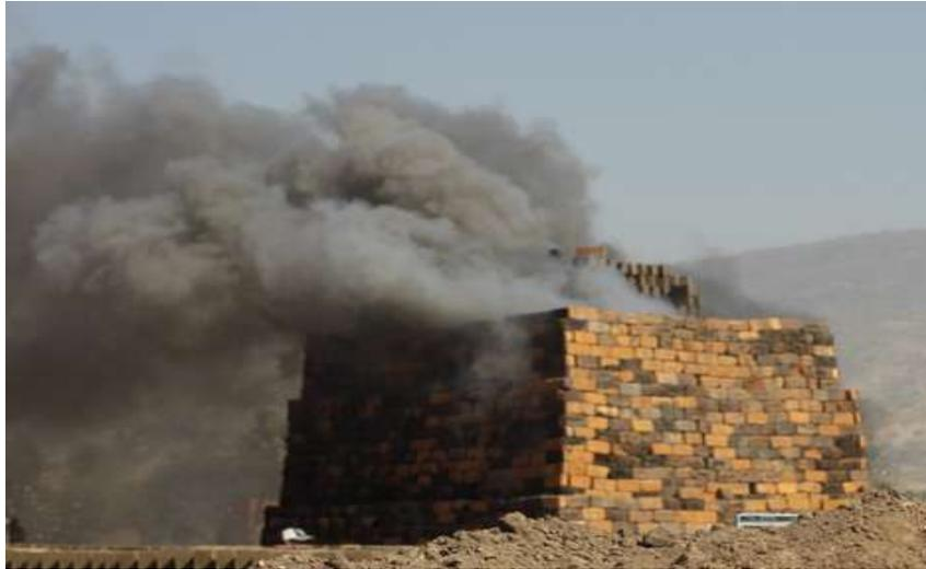
**Fig. 7** Horno Ladrillero quemado con aceite quemado.
