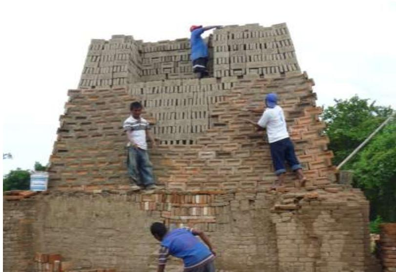
**Fig.12** Carga al horno y acomodo de ladrillos
