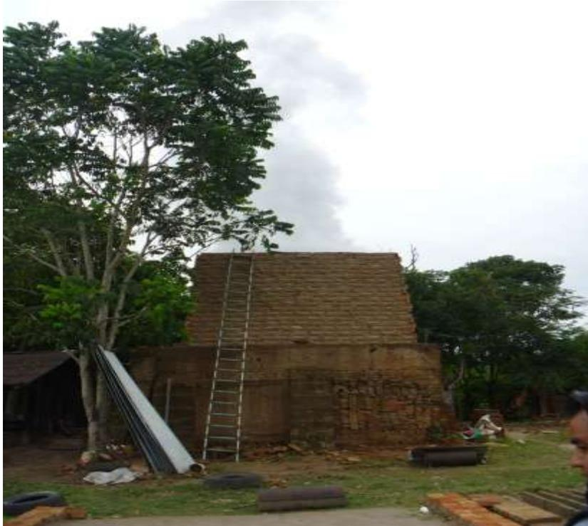
**Fig.14** Horno en proceso de cocción
