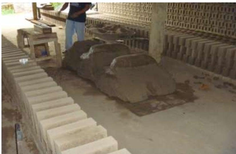
**Fig. 9** Mezcla para moldeo de ladrillo
