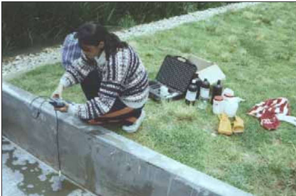
Figura 14: Medición in situ del pH, del potencial mV y de la temperatura en las cajas de de aireación. En el segundo plano se reconoce las distintas botellas de muestreo y una caja con el kit para la determinación de oxígeno disuelto durante el programa de investigación.
