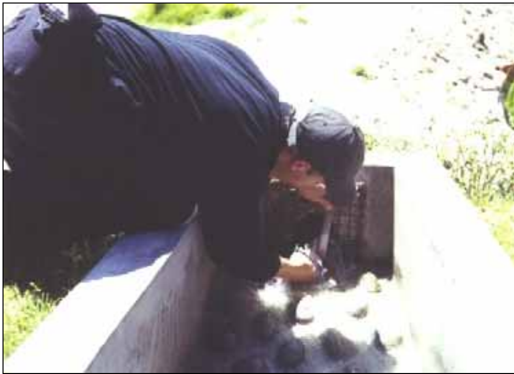
Figura 13: Medición de la altura de agua en la tubería de conexión al sistema principal y de distribución entre las distintas celdas de purificación para la computación de los correspondientes caudales durante el programa de investigación.
