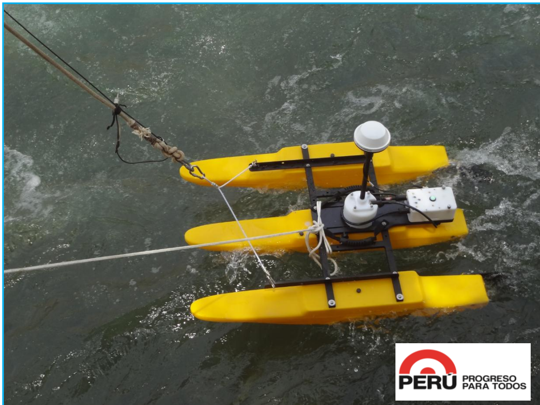
Foto: ADCP Sontek M9 Multifrecuencia, aforando en el río Rímac estación hidrológica Chosica (Setiembre 2013).
