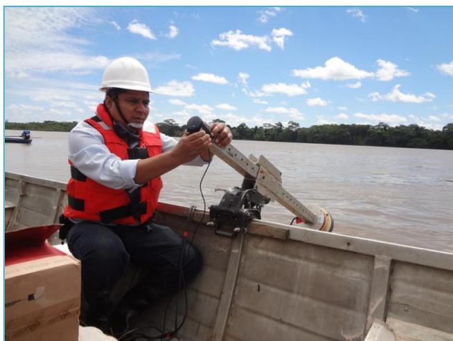
**Foto 5.** Instalando la antena GPS al ADCP
