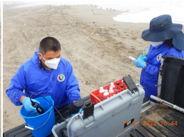
Figura 5.- Registro de variables oceanográficas, con el multiparámetro YSI PRO Dss. Playa Chacra y Mar. 11.03.2022
