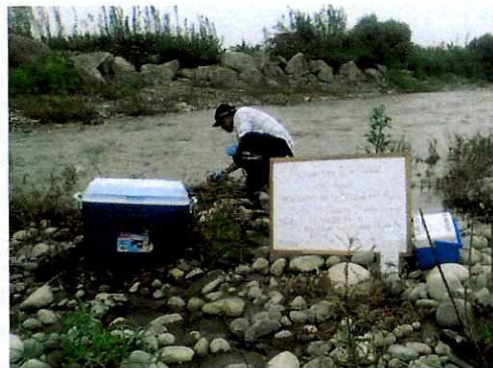
Foto se observa la toma de muestra en el punto de monitoreo 137558RChhu5, ubicado en el río Chancay-Huaral, Puente Boza
