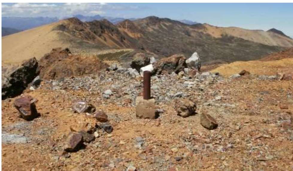
Fotografía N°5-4 Perforación Cerrada N°4
