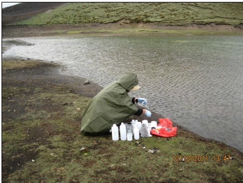
En la siguiente imagen se puede apreciar el muestreo de calidad de agua en el punto CA-2.
