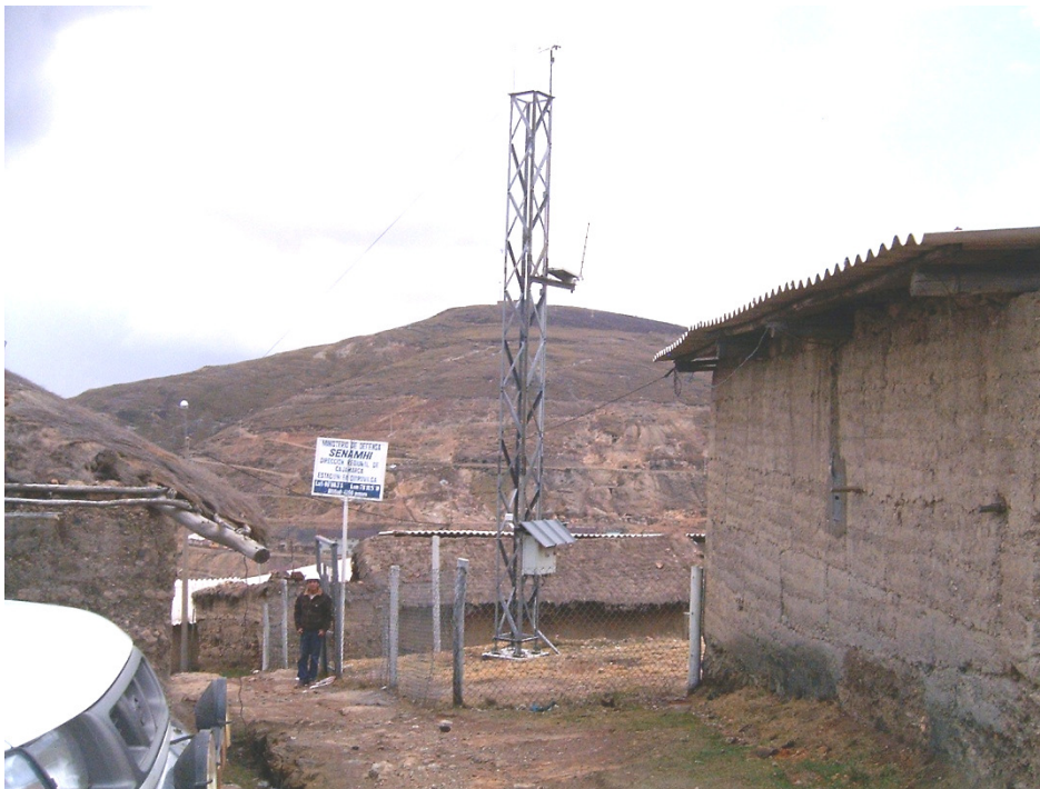
Estación Meteorológica Automática "Quiruvilca"
