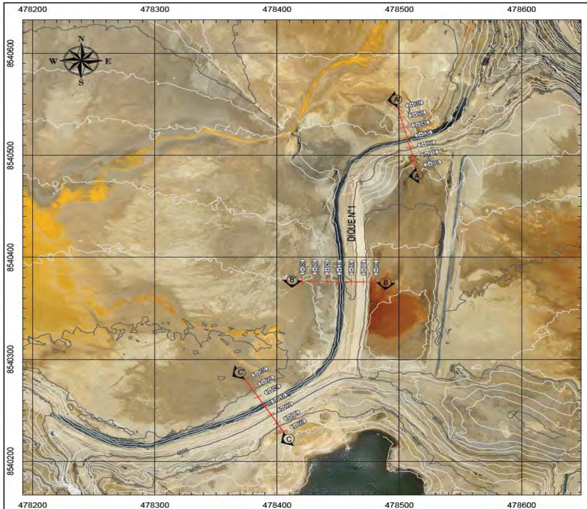
Figura 7. Vista en planta del Dique N°1, cortes.
