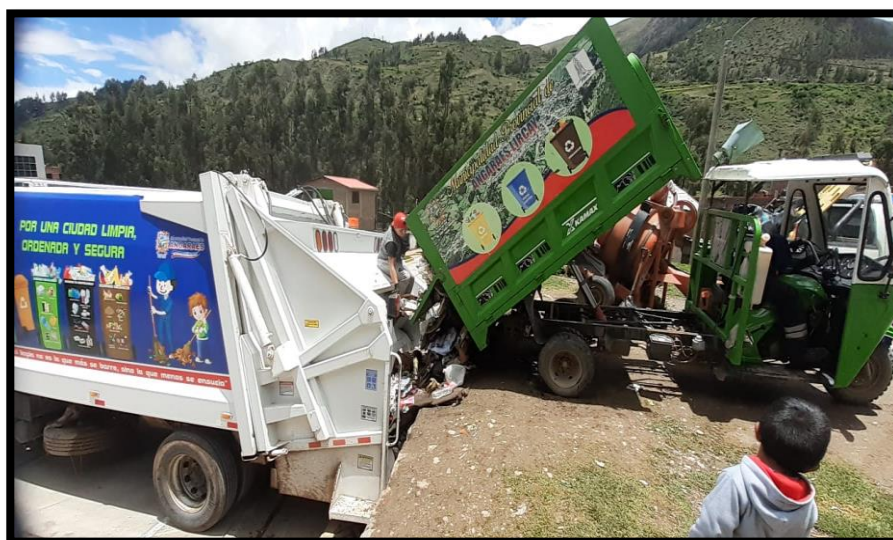
Foto 22 Transferencia de residuos sólidos
