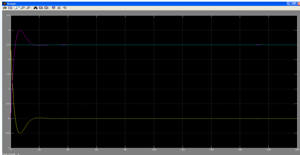
Figura 4: Curva de respuesta del sistema para una humedad relativa del 50%
