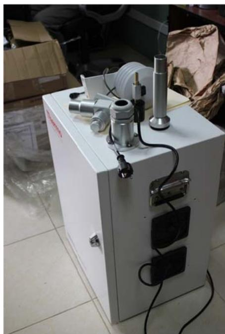
**IMR – 2800**, Equipo llamado Gasómetro, sirve para la medición de gases contaminantes producidos por la combustión. Tanto vehicular, industrial (ladrilleras), comercial (hornos, chimeneas) y otros.
