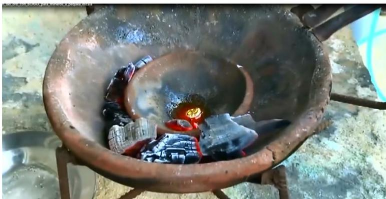
**Foto 8 – Crisol con carbón vegetal y el concentrado más bórax fundido. En el fondo se puede ver la pepita de oro fundido.**
