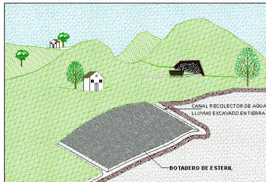
Figura N° 42: Construcción de botaderos
