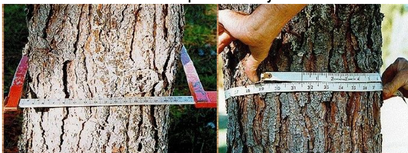
FIGURA N° 066: Forcipula de metal y cinta métrica
