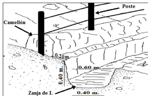
**17- Tendido de alambre de púa:** El tendido de los alambres de púas se realizarán distanciados a 0.30 m entre cada hilera (3 hileras) para asegurar el tensado se fijaran con grapas en cada uno de los postes.
