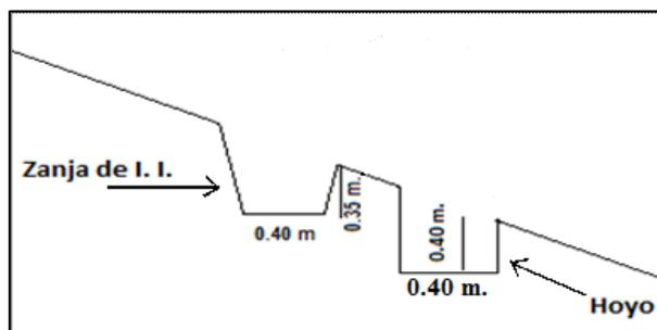
**Figura N° 16: Apertura de zanjas de infiltración individual**
