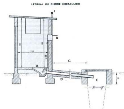
pozo séptico está desplazado con respecto a la letrina, ambos están conectados por una tubería de longitud variable, en material PVC. La loza turca o inodoro queda instalado en la caseta y se puede construir en el interior de la casa o patio, dentro del entorno familiar.
