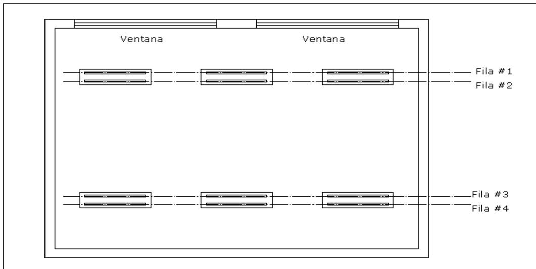
Esquema de control del sistema de iluminación de la sala mostrada
