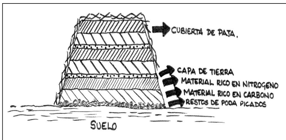
GRAFICO Nº 06 CORTE TRANSVERSAL DE UNA COMPOSTERA
