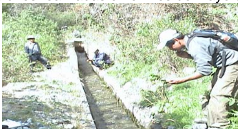
Foto 13: Aforos realizados en el canal de riego
