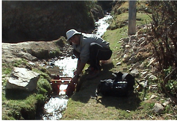
Figura 17: Aforo en la microcuenca de Chacña
