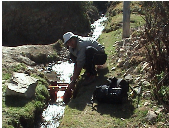
Foto 15: Aforo en la microcuenca de Tintay
