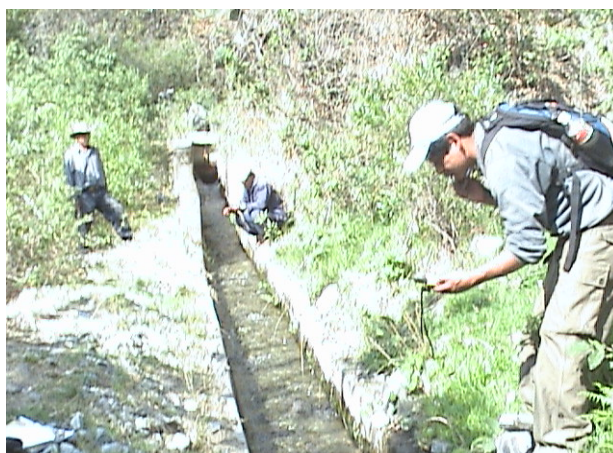
Figura 13: Aforos realizados en el canal de riego (Circa)
