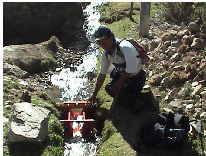
Foto 12: Aforos realizados en la microcuenca de Chacoche
