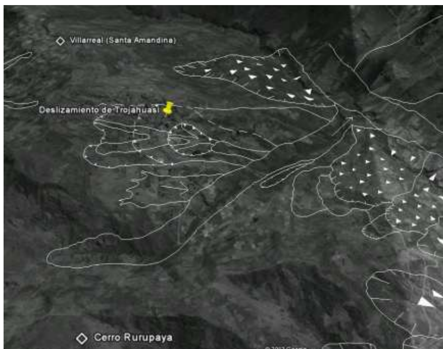
Figura 8. Movimientos en masa reconocidos en Trujahuasi (distrito de Kaquiabamba, provincia de Andahuaylas) y alrededores sobre imagen de Google Earth.
